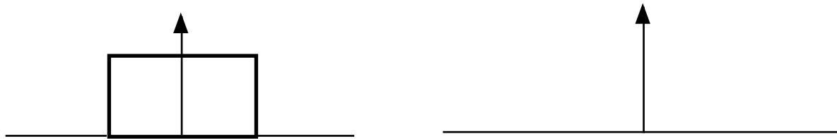
Abbildung: Wellenpaket und Fouriertransformierte bei einem Rechteckpaket.
